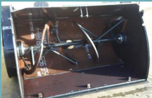
Усиление 4-5мм сталью HARDOX-450 Опция
