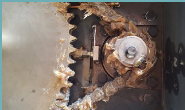
Цепной гидропривод расположен ВНЕ ковша, 30об/мин Стандарт
